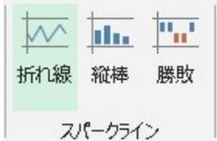
まずは上図のような表を作成する。スパークラインを設定したい設定先のF3:F5をドラッグし、リボンメニューの[挿入]→[スパークライン]→[折れ線]を選択。
